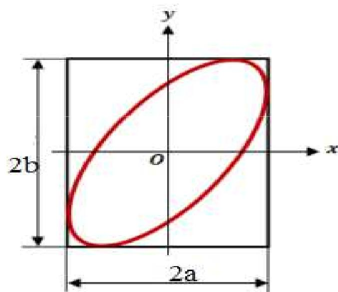
Sur un oscilloscope utilisé en mode XY, on applique sur l'entrée X la tension  $X = A \cos(\omega \cdot t)$
